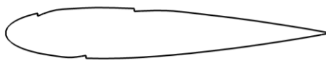
شکل 4- مقطع بال اصلاح شده بر اساس یک شکاف در سطح فشاری و دو شکاف در سطح مکشی.
